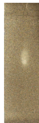
Figura 2. Atividade anti-fúngica do composto purificado do extrato de folhas de C. verticillata em acetato de etila. Cromatoplaça desenvolvida em clorofórmio: metanol (1:1). Rf do composto ativo 0,53.
